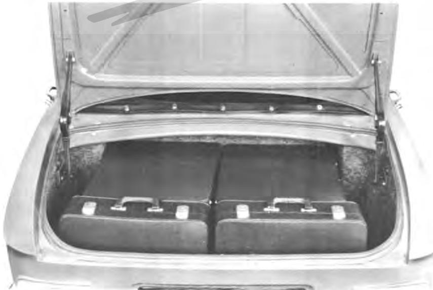
Der Kofferraum des Cabriolets mit dem beachtlichen Ladeinhalt von 285 dm<sup>3</sup> ist vollständig gepolstert.
