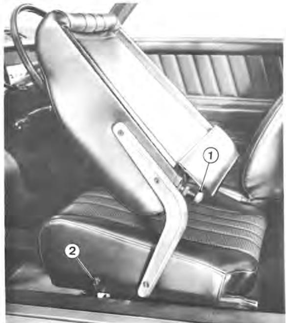
Die **Gleitschienen**, die denen der Limousine gleichen, ermöglichen eine grösstmögliche Längsverstellung der Sitze, welche durch den Hebel 2 bedient wird.
