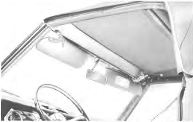
Das Cabriolet besitzt zwei Sonnenblenden, die sich von denen der Limousine und des Coupés unterscheiden ; an der Sonnenblende des Beifahrers befindet sich ebenfalls ein Spiegel.
